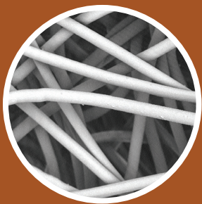
Feltro em poliéster padrão ampliado 300 vezes.
